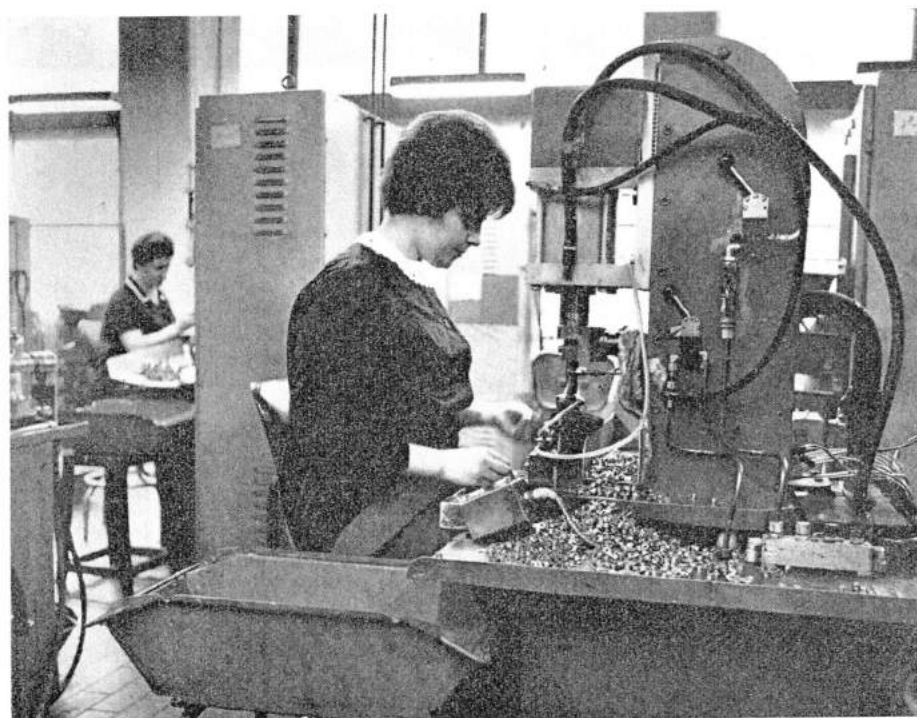
Ivrea. Un aspetto del reparto torni automatici nell'officina H (foto in alto). Oltre duecento torni, raggruppati secondo le loro caratteristiche tecniche, producono tutte le parti delle macchine da calcolo e da scrivere ricavate da barre d'acciaio, e quindi anche quelle della Logos. In basso, un aspetto del reparto saldatrici elettroniche.
